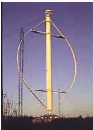
Fig. 1.4 Aerogeneradores con Turbinas Tipo Darrieus, con velocidad de rotación fija.
